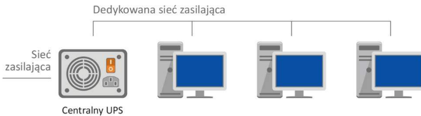
Rys. 13. Centralny system zasilania awaryjnego
